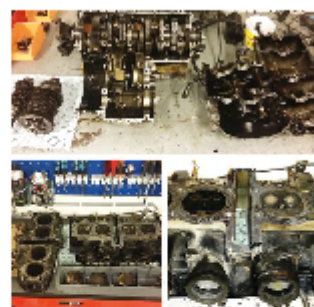
Motoren var relativt sliten. Det var mer koks her enn i en gammel løtul. I tillegg raslet det friskt i både dynamokjedet og registerkjedet. LA an til en ikke planlagt motoroverhaling.
