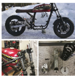
Test av høyder og fjæringsvei en fin vinterdag. Den er hevet ca 4 cm på demperen bak, samt senket ca. 5 cm på guffelen foran.
